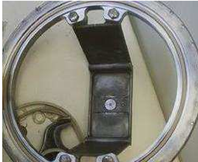
Вытягивающий электрод со сменной вставкой. Установлен на охлаждаемом фланце Боковые окна обеспечивают откачку вытягивающего зазора
