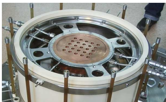
Вытягивающий электрод (ВЭ) с 25 отверстиями
