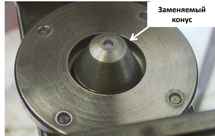
Охлаждаемый ускоряющий электрод
