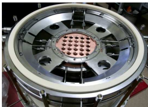
Плазменный электрод (ПЭ) с 21 отверстием
